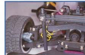
Notez les différents points de fixation des différents éléments du support de carrosserie.
