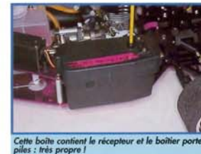
Cette boîte contient le récepteur et le boîtier porte piles : très propre !
