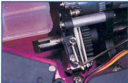
Cette noix témoigne que l'on peut monter un cardan vers la cellule avant : on peut donc transformer ce 4x2 en 4x4. Le frein est très efficace.
