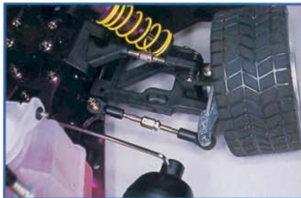
D'origine, des biellettes à pas inversé. Notez la goutte de frein-filet sur la vis de fusée : par-fait !
