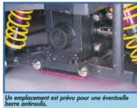
D'origine, des biellettes à pas inversé. Notez la goutte de frein-filet sur la vis de fusée : par-fait !
