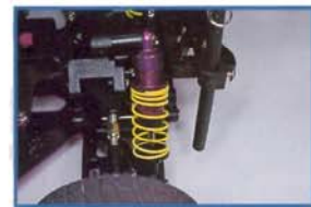
On peut comprimer les ressorts des amortisseurs en vissant cette bague.
