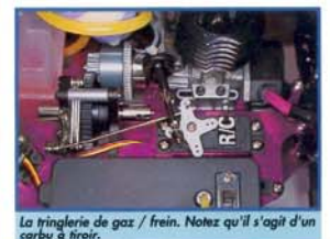
La tringlerie de gaz / frein. Notez qu'il s'agit d'un carbu à tiroir.
