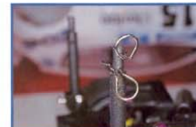
Astuce : avec deux clips, la fixation arrière de carrosserie est nettement meilleure. Il suffit de repercer un trou un peu plus bas.
