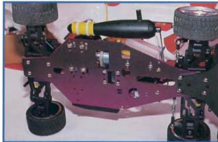
Châssis anodisé mais non fraisé (pas indispensable en loisir).
