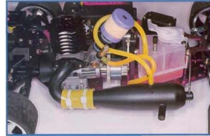
Le moteur est un Delta 15 (2,5cc). Les périphériques sont à la hauteur. Seule remarque : attention aux passages de Durit (pas trop près du volant moteur !).
