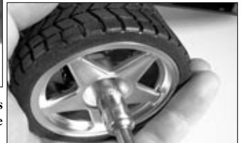
**Monter les roues et les bloquer à l'aide d'une clé de 7 mm.**
