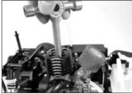
2- Revisser la bougie sur la culasse à l'aide d'une clé à pipe de 8 mm ou avec la clé à bougie multi-fonctions AVIORACING Réf. 56000329
