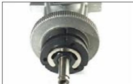
**C. Installer le volant et les masselottes d'embrayage.**
