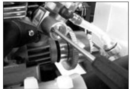
9- Le réglage du ralenti s'effectue avec un petit tournevis plat (petite vis à ressort sur le côté du carburateur). Visser pour monter le ralenti et dévisser pour baisser le ralenti.
