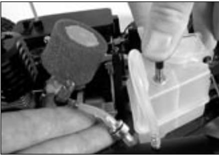
4- Presser la pompe du réservoir pour amorcer le carburateur. Vous devez voir monter le carburant au carburateur par la durite d'alimentation.
