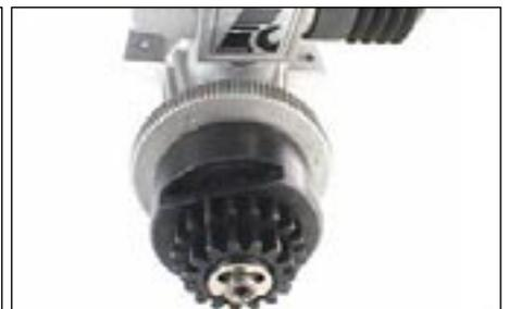
**E. Fixer la cloche sur la sortie du vilbrequin avec le circlips (21).**
