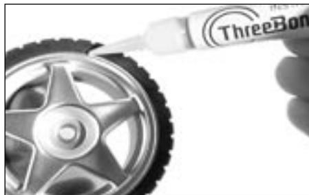
**Monter les pneus sur les jantes et les coller avec un peu de colle cyanoacrylate spécial caoutchouc (réf. 64001731).**
