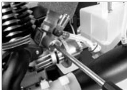
8- Le réglage de la vis de reprise s'effectue à l'aide d'un petit tournevis plat. Visser pour appauvrir et dévisser pour enrichir.
