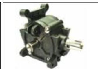
Démonter la transmission avant et l'assembler comme indiqué ci-dessus.
